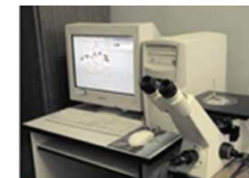
*Общий вид автоматизированной системы АТЛАНТ для измерения параметров микроструктуры топливных таблеток из диоксида урана*
