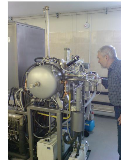
*Высокотемпературная установка для исследования физико-механических свойств перспективных конструкционных материалов*
