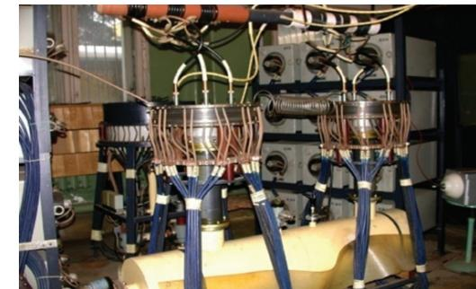
*Импульсная плазменная установка Десна-М*
