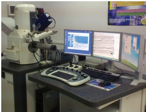
*Растровый электронный микроскоп Carl Zeiss EVO 50 с разрешением 3 нм. Назначение: исследование топографии и структуры поверхности, получение изображения во вторичных и обратнорассеянных электронах, с использованием рентгеноспектрального микроанализа элементного состава с помощью энергодисперсионного и волнодисперсионного спектрометров (EDS, WDS) и детектора дифракции обратнорассеянных электронов для анализа фазового состава и текстуры (EBSD)*
