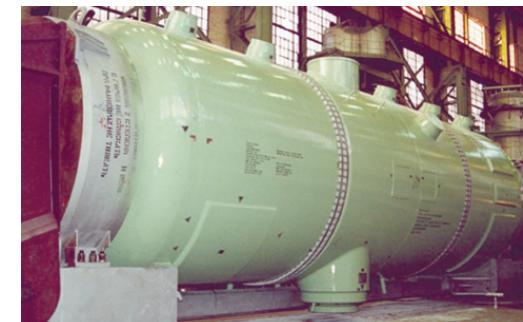
*Парогенератор ПГВ-1000М для АЭС с реакторами ВВЭР-1000*
