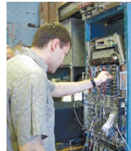
*Проведение испытаний детекторов для космического гамма-телескопа по обнаружению следов «темной материи» с кодовым названием «встречные пучки»*
