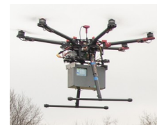
Коптер с модулем отбора аэрозольных частиц для био-мониторинга
