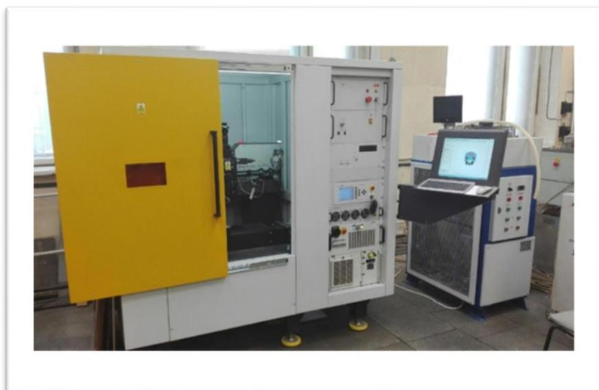
Установка для микрообработки на базе твердотельного лазера с диодной накачкой
